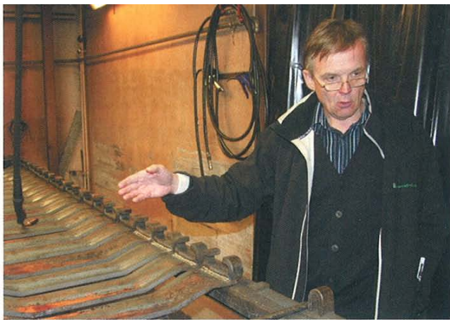
Telamallit suunnitellaan hyvin tarkasti erilaisiin olosuhteisiin. Vahva sivuketjulinja ja pyörästetyt telakengät tekevät tästä mallista sopivan erityisesti Baltian kosteille ja teloja kuluttaville hiesumaille. Pyöreäsivuinen telakenkä ei riko risumattoa koneen alta, näyttää Hannu Hypén.
