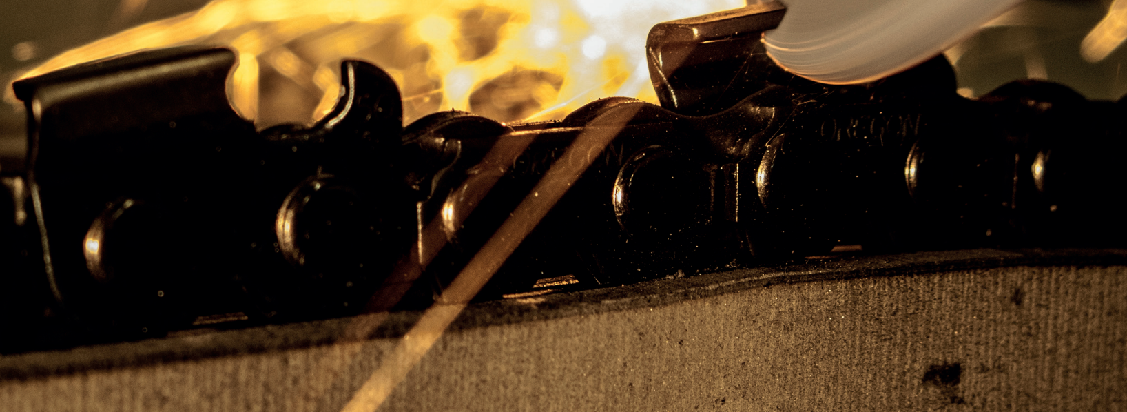
Teräketjun teroituksessa on oleellista leikkuuhampaan oikeat kulmat ja teroitus leikkuuhammasta vaurioittamatta esimerkiksi ylikuumentamisella.
