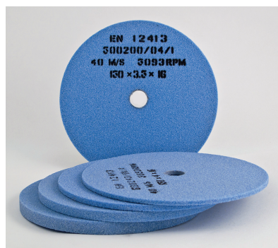
Teroituskiven valinta on tärkeä onnistuneeseen lopputulokseen. Liian hienorakeinen kivi polttaa helposti leikkuuhampaan reunan.
