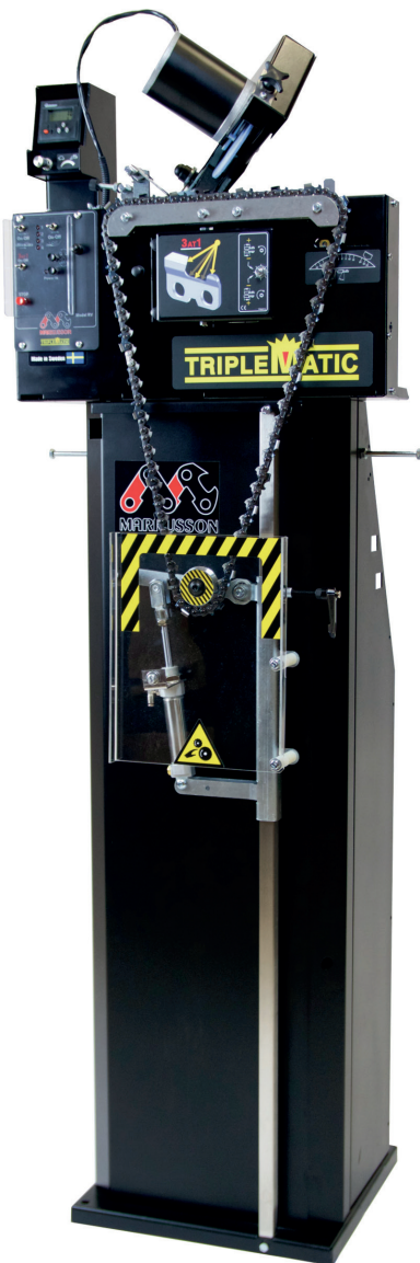
Triplematic on kolmivaiheteroituksen tekevä, leikkuuhammaslaskurilla varustettu teroitusautomaatti. Toimitusvarustukseen kuuluu myös asennusteline ja paineilmatoiminen ketjukiristys.
